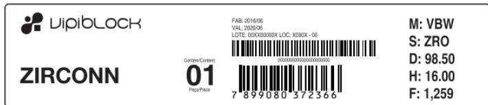
\*Os blocos **VIPIBLOCK ZIRCONN** são fabricados sob rigoroso controle de processamento, possibilitando assim, variações mínimas de retração entre diferentes lotes. Mesmo assim, cada bloco possui sua identificação particular com o correspondente fator de magnificação a ser informado ao sistema de fresagem durante a sua utilização.
